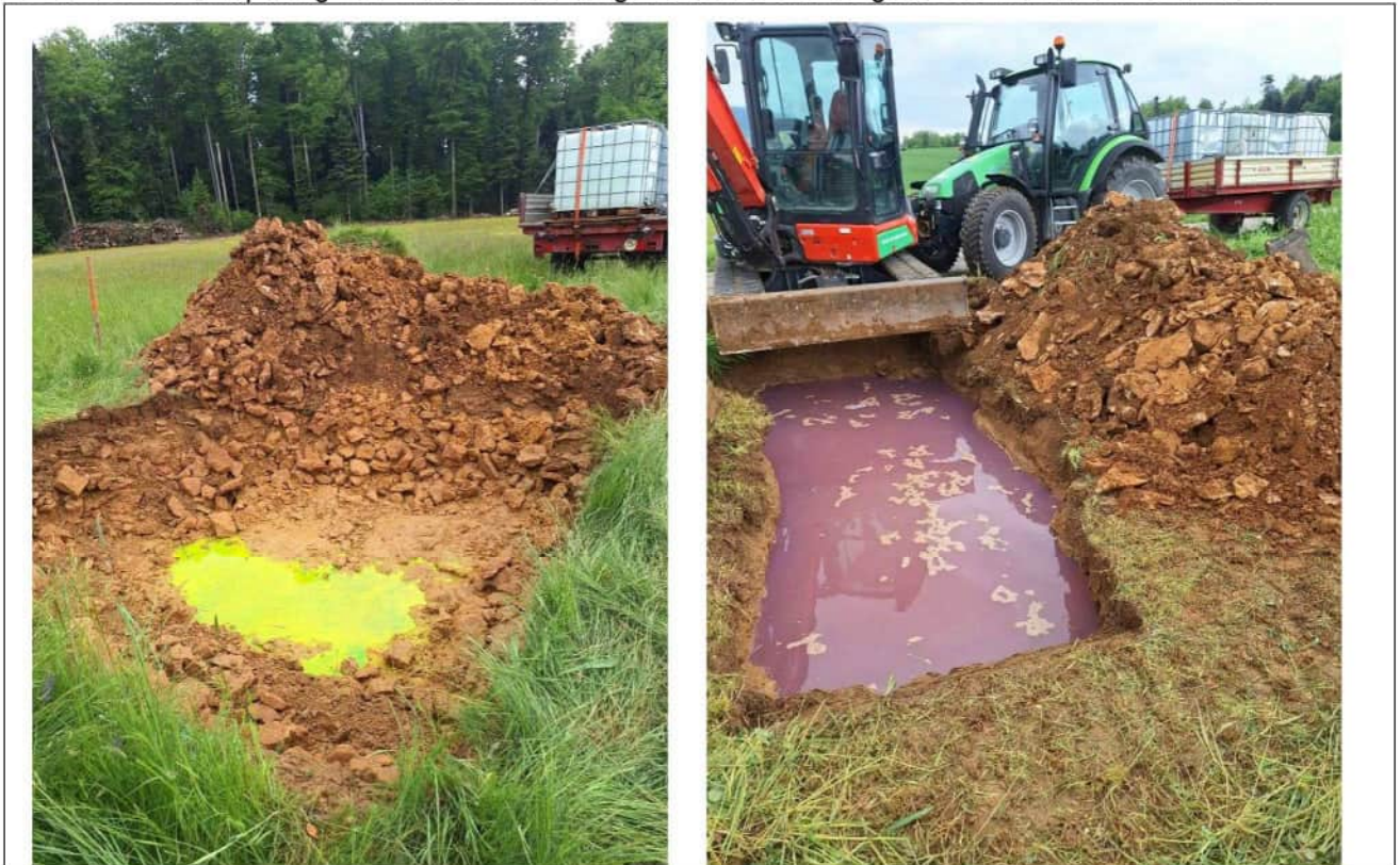
Foto 11: Wasserstand in Eingabestelle 1 beim Nachspülen
