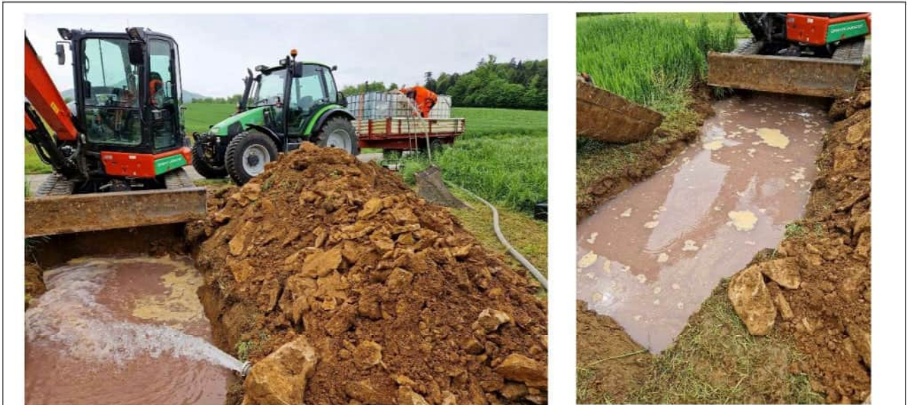
Foto 9 & 10: Einspülung von Wasser in die Eingabestelle 2 und Eingabe des Markierstoffs Amino G
